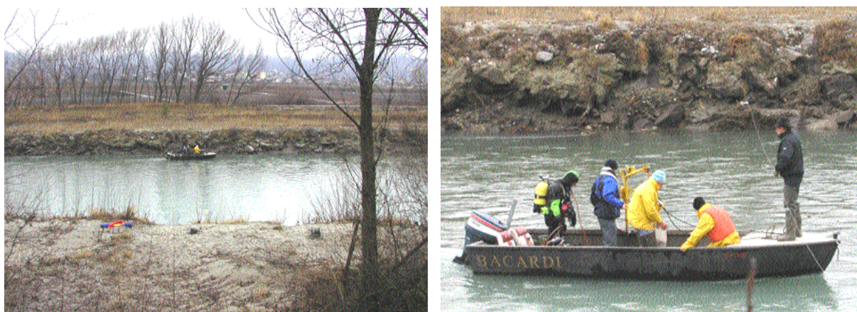
Abbildung 2. Probenahme im Querprofil Riddes 2 der Rhone am 2.3.2002. Linkes Bild: Blick von der Dammkrone über das Querprofil Richtung Norden. Zu sehen sind die beidseitigen Vorländer und das zentrale, mit Blockwurf verbaute Gerinne. Rechtes Bild: Boot mit Führungsleine für die morphologisch-hydraulischen Aufnahmen und die Benthos-Probenahme durch Taucher über die ganze Flussbreite.
