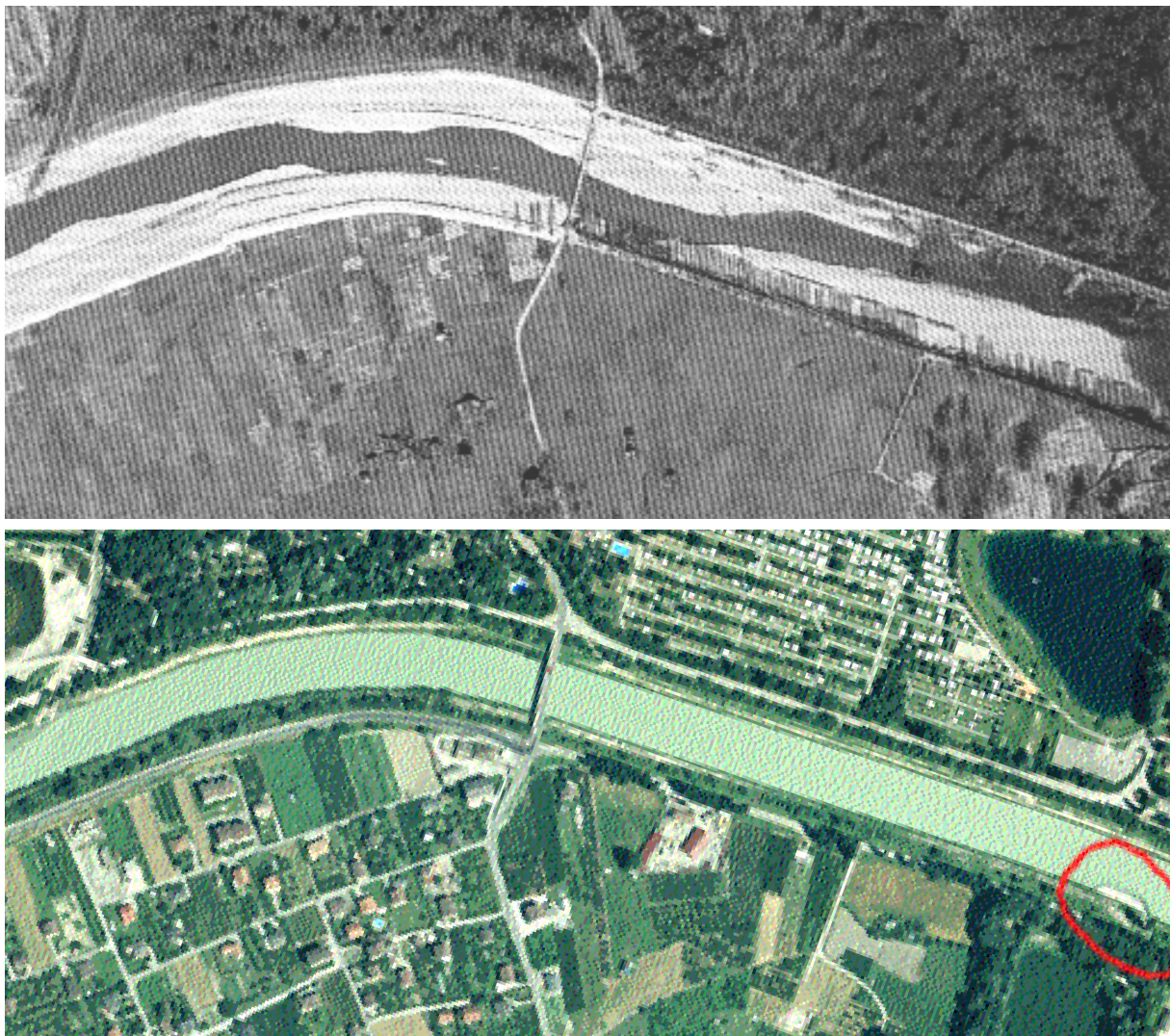
Abbildung 21. Rhonelauf bei Aproz zwischen den Mündungen von Printse (rechter Bildrand) und Morge (linker Rand) auf Luftaufnahmen aus verschiedenen Perioden. Fließrichtung der Rhone von rechts nach links. Oberes Bild: Zustand bei tiefer Wasserführung am 21.3.1938 vor Abschluss der 2. Rhonekorrektur mit gut ausgebildeten Kiesbänken. 1949, nach Abschluss der Korrektur, waren diese Bänke vollständig verschwunden. Aus SFRD (1964). Unteres Bild: Zustand bei hoher Wasserführung im Sommer 1999 oder 2000. Flussabwärts der Printse-Mündung hat sich wieder eine kleine Kiesbank gebildet (rot umrandet). Aufnahme "Swissimage", © Office fédéral de topographie (DV023268).
